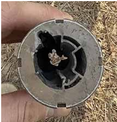
Vienas iš neatsparių konstrukcinių mazgų – sulūžęs ugnies ir garso slopintuvas.
