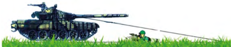
39 pav. Tankų T-72, T-80, T-90 ginklams nepasiekiamą (akloji) zoną iš priekio – 20 m
