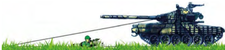
40 pav. Tankų T-72, T-80, T-90 ginklams nepasiekiamą (akloji) zoną iš galo – 35 m
