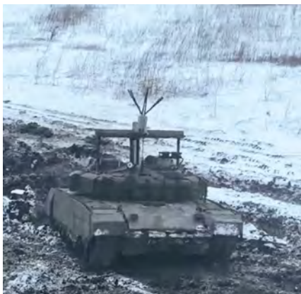
51 pav. Elektroninės kovos priemonė „Saniya“
