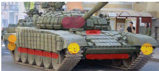
44 pav. Tankų T-72BV, T-80BV pažeidžiamos zonos šaudant į priekį
