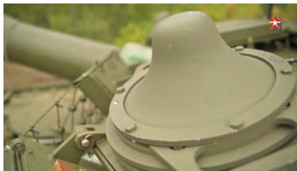
52 pav. Elektroninės kovos priemonė „Volnorez“
