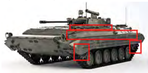
47 pav. Pėstininkų kovos mašinų BMP1 ir BMP2 pažeidžiamos zonos
