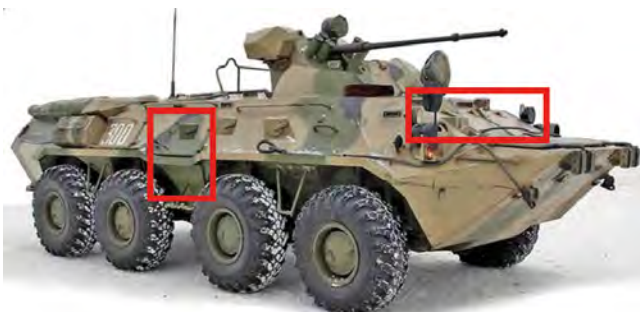
48 pav. Šarvuotųjų BTR pažeidžiamos zonos
