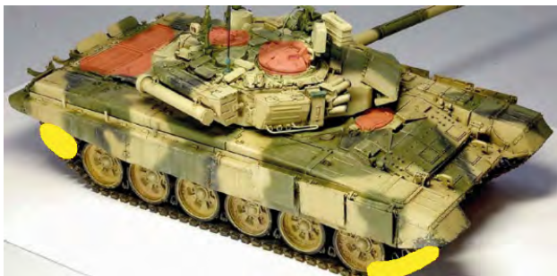
46 pav. Tankų T-72, T-80 ir T-90 pažeidžiamos zonos šaudant iš viršaus
