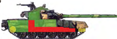
43 pav. Tankų T-72BM, T-72BA1, T-72B3, T80U, T-90, T-90A pažeidžiamos zonos šaudant į šoną
