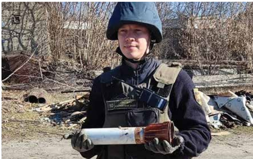
Šis nedidelis objektas kario rankose – vienas iš klaidinančių taikinių, kuriuos išmeta Iskander skrydžio metu. Iš esmės tai radijo trikdžių švyturys ir šiluminis šaltinis.
